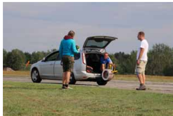
Mit einer Winde, die am Heck des Austos befestigt ist, ist ein sicheres Schleppen der Fluggeräte in gut 100 Meter Höhe möglich.
