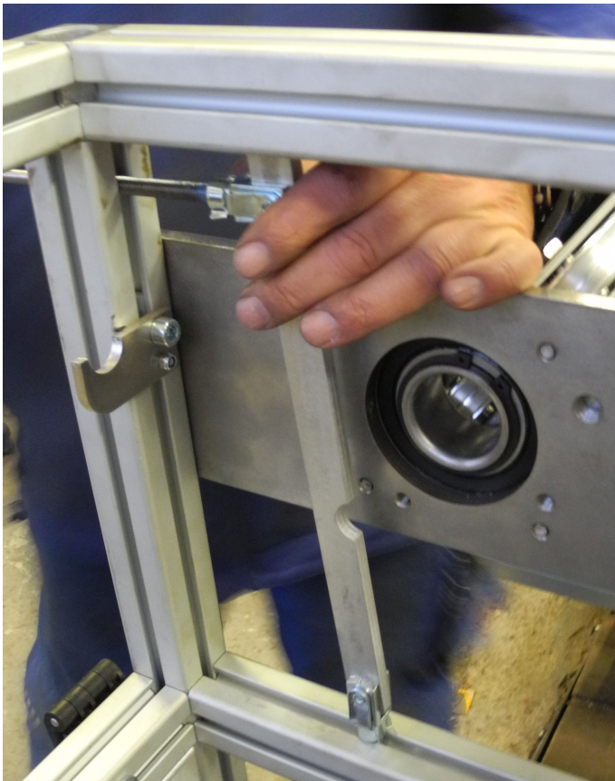
Roland baut die erste Not-Handauslösung für die Kappvorrichtung ein.
