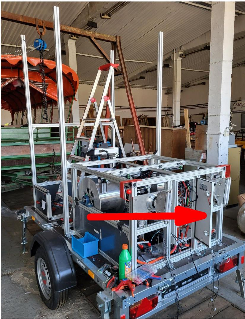
An Winde 2 sind die Stützen für den Sonnenschutz angebaut.
